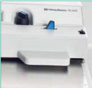
Durch zwei voreingestellte Tiefen und eine zusätzliche manuelle Einstellfunktion (0,25 mm bis 1,78 mm) lässt sich die Schnitttiefe an unterschiedliche Kuvertformate anpassen.
