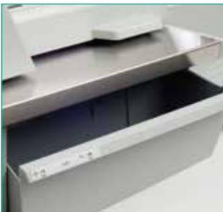
Der Papierabfall wird in einem leicht zu entleerenden Abfallbehälter aufgefangen. Nach der Verarbeitung von 3.500 Kuverts zeigt ein Licht an, dass der Behälter sich mit Fräsabfällen füllt.
