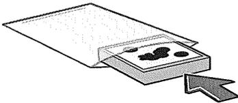
D 新しい廃液トレイを引き出しにセットし、引き出しを閉じます。
