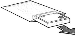
B 計器右側面下部にあるトレイの引き出しを開け、廃液トレイを取り外します。
