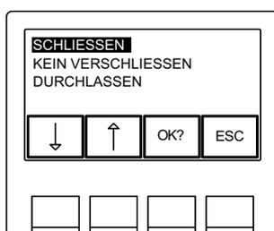
Wählen Sie den gewünschten Maschinenmodus: nämlich "KUVERTIEREN" (Einstecken und Verschicken), "KEIN VERSCHLUSS" (Einstecken ohne Verschließen) oder "DURCHLASSEN" (ohne Einstecken).
