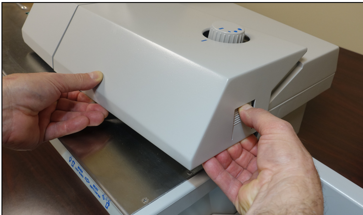
Figure 2-9 : Déclenchement de l'interverrouillage en cas de retrait du couvercle supérieur
