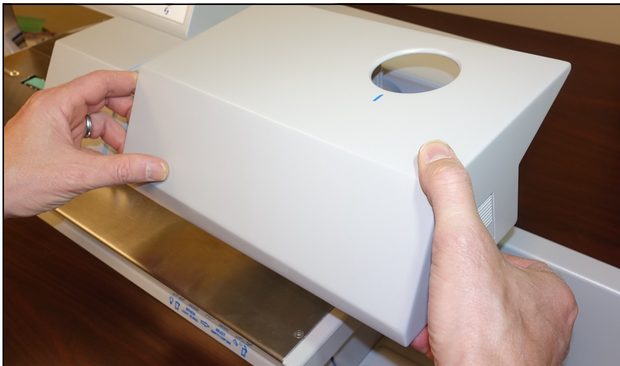
Figure 4-14 : Soulevez le couvercle du bras de pincement
