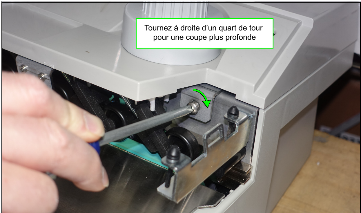
Figure 4-20 : Réglage de la profondeur de la fraise
