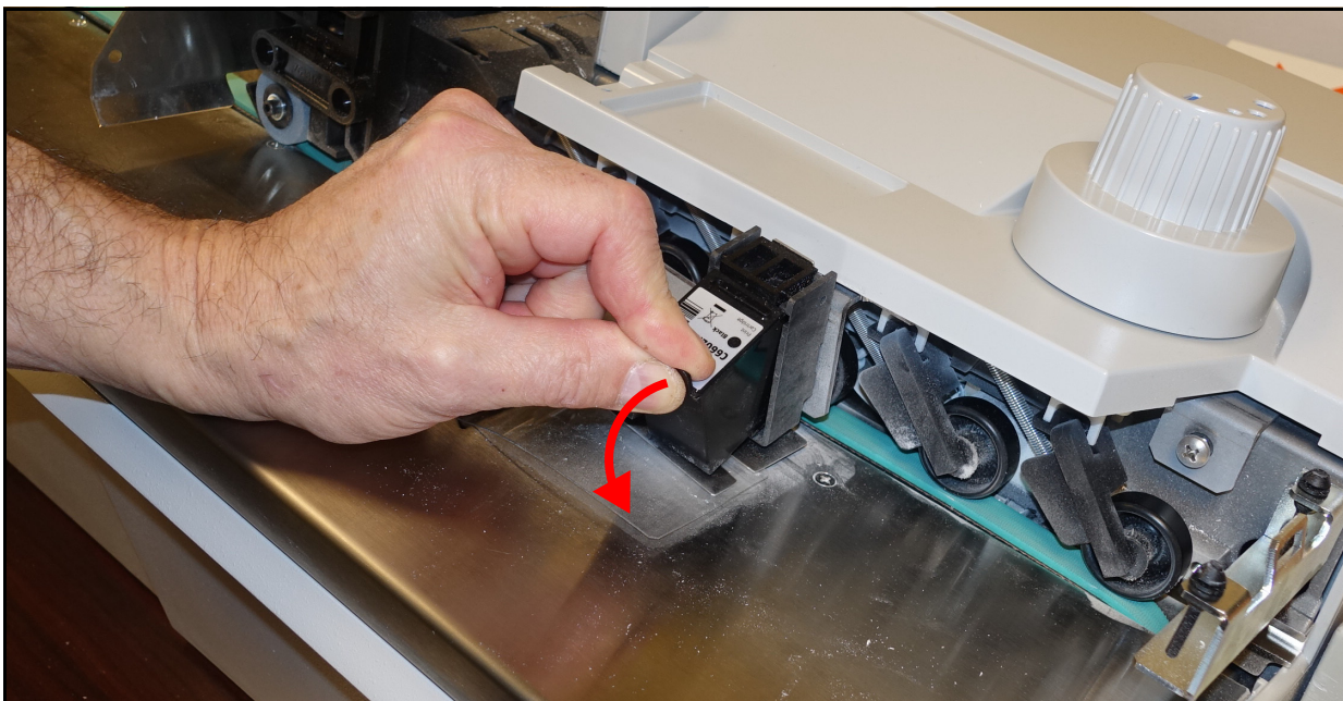
Figure 4-17 : Retrait de la cartouche d'impression
