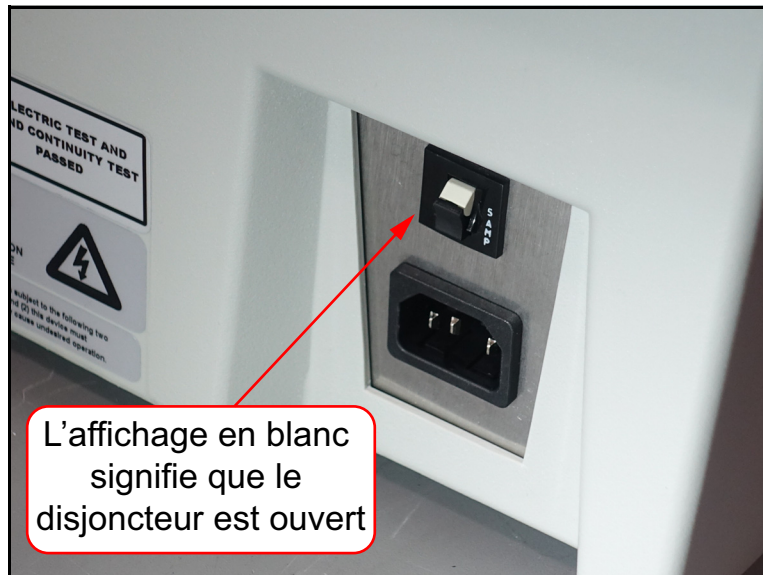
Figure 4-21 : Ouverture du disjoncteur
